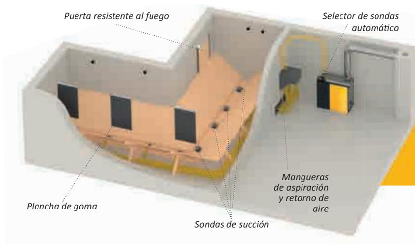
Con las sondas de succión se puede utilizar casi cualquier local como depósito, aunque no sea recto. En depósitos más grandes también se pueden instalar 8 sondas de succión.
