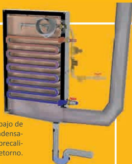
El humo se enfría por debajo de la temperatura de condensación. Con este calor se precalienta el agua del retorno.
