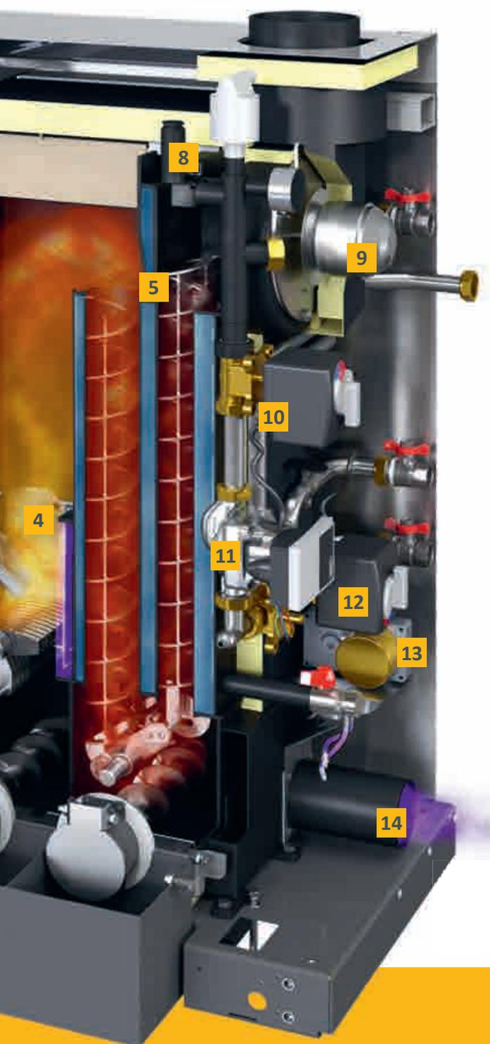
**8 Elementos de seguridad:** La caldera dispone de válvula de seguridad y sensor electrónico de presión para proteger contra presión excesiva. También tiene un purgador rápido integrado, para sacar el aire indeseado de los circuitos de calefacción. La caldera no necesita ninguna válvula de descarga térmica, ya que la cantidad de combustible dentro es tan pequeña que no hay riesgo de sobrecalentamiento.
